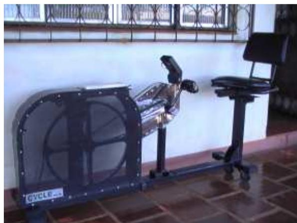
Figura 2: Protótipo de cicloergômetro de membros inferiores com graduação de carga
